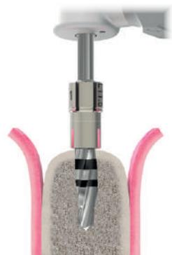
Continúe la secuencia de fresado con la Fresa Piloto 2 Ref. OTD301C, hasta la longitud total correspondiente al implante seleccionado. Esté atento a la marca láser de la fresa que le indica la longitud o use el tope de fresa Ref. ZMPD115. Controle la dirección e inclinación del fresado, realizando presión intermitente siempre en sentido vertical, con cuidado de no generar presión excesiva sobre el hueso. De ser necesario, use el prolongador de fresas Ref. DEXT10.
